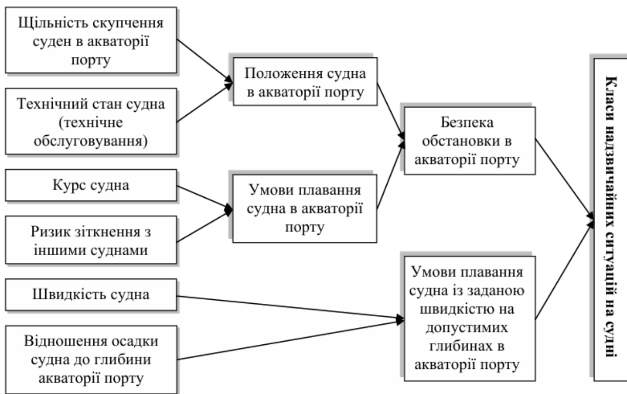
Рисунок 2.6 – Логіко-лінгвістична ієрархічна продукційна модель класифікації надзвичайних ситуацій на судні в акваторії порту
